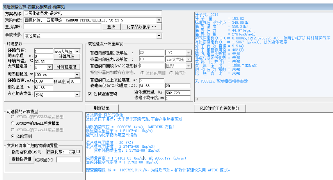
图 6.5-2 四氯化碳液池蒸发源强计算图
